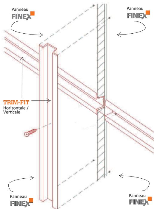
Choix de 3 moulures extrudées en aluminium structural d'une longueur de 2440 mm (8') avec mousse compressible sur la surface arrière des ailettes pour minimiser l'infiltration d'eau.
